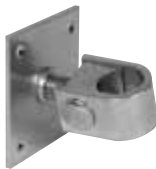
Zincato / Zinc-Plated Art. 15.131 Cardine 18 MA per □30 - piastra 90 X 90 X 4 Art. 15.132 Cardine 22 MA per □35 - piastra 110 X 110 X 5 Art. 15.133 Cardine 27 MA per □40 - piastra 130 X 130 X 5
